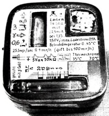
Bild 4. Ansicht des 66 mm x 58 mm x 30 mm großen Strahlungsmessgerätes
